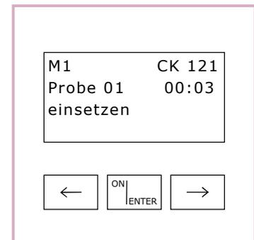
**6.** Bei Aufforderung erste Küvette zur Messung **M1** ins Gerät einsetzen
