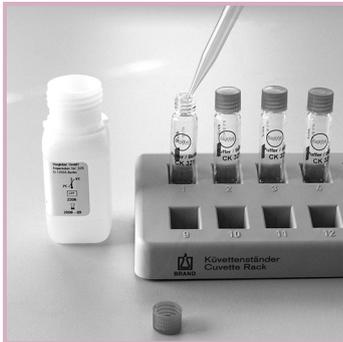
**1.** Jeweils 500 µL Enzym-Substrat-Lösung in jede Küvette pipettieren
