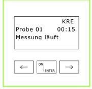
**6.** Die erste Küvette in das Photometer einsetzen Zeitablauf (2 Minuten) wird angezeigt
