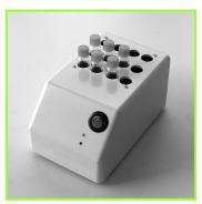
**2.** Küvetten 7 Minuten im vorgeheizten Thermostaten inkubieren
