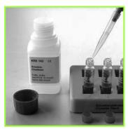
1 mL Pufferlösung in jede Küvette pipettieren
