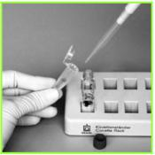
3. 500 µL Probe in jede Küvette überführen Tipp: Jede Küvette einzeln bearbeiten und sofort in den Thermostaten zurückstellen, um Abkühlung zu vermeiden.
