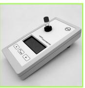
**8.** Nach Ergebnisanzeige der Probe 1 **sofort** alle weiteren Küvetten in gleicher Weise messen
